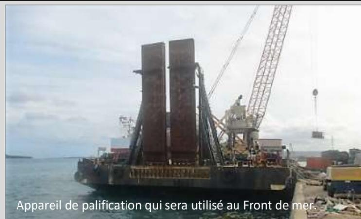
Appareil de palification qui sera utilisé au Front de mer.
